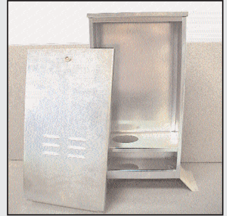
ARCG : coffret en acier galvanisé à clés Dimensions : L280xH700xP170 mm L = largeur H = hauteur P = profondeur Livré support à sceller ou à boulonner . Idéal pour l'installation d'un coffret de gestion pour moteur coulissant en copropriété et usine .
